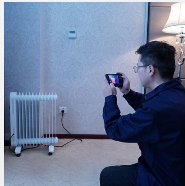
Обнаружение утечек тепла
