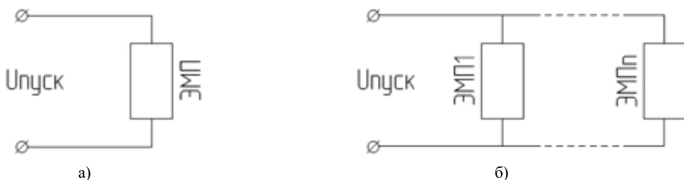
Рис. 5 Схема подключения ЭМП: а) одного модуля, б) нескольких модулей
