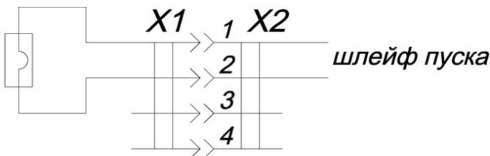
Рис 3. Схема подключения модуля к шлейфу пуска.
