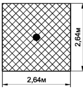
Рис.4 Масштабное изображение конфигурации распыла огнетушащего порошка.
