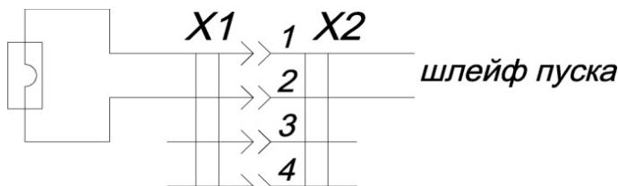
Рис 3. Схема подключения модуля к шлейфу пуска.
