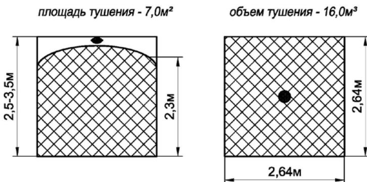
Рис.4 Масштабное изображение конфигурации распыла огнетушащего порошка.
